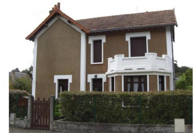
Maison en maçonnerie récente (béton, ciment, parpaing), dont la façade est travaillée avec des peintures et un enduit à la tyrolienne
