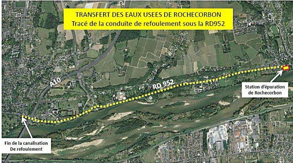
La station de Rochecorbon sera ensuite démantelée et remplacée par un poste de refoulement. Les travaux de raccordement au réseau de Tours sont prévus sur les années 2018-2019.
