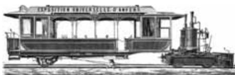
Une curiosité : l'avant de la motrice peut être soulevé et le moteur resté sur les rails peut alors être enlevé et remplacé par un moteur refait à neuf.
