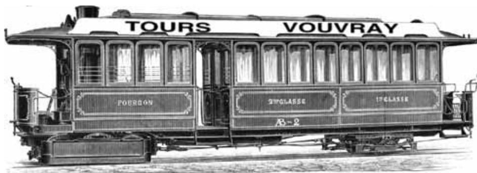
Automotrice Rowan, 1889 à 1899. Une merveille de technique et de compacité : de gauche à droite le poste du wattman (conducteur), le moteur à vapeur, un fourgon puis les compartiments de seconde et première classes.
